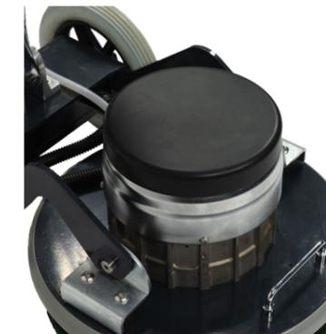
Motorschutzabdeckung schützt den Motor vor Feuchtigkeit.
