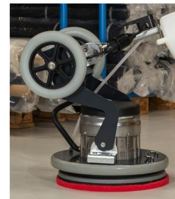
Kippbare Deichsel zur Erhöhung des Anpressdruckes.
