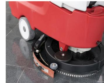
Saugbalken schwenkt automatisch in die Arbeitsrichtung.
