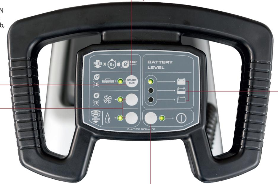
Absaugung und Wasserzufuhr kann individuell einzeln zu- und abgeschaltet werden.
